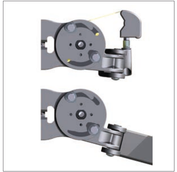
Die Seitenansicht mit der stufenlosen Neigungsverstellung von 10 bis 80 Grad.
