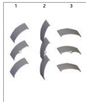
Option: Arbeitsstellung: 1. Absenken des Behangs mit geöffneten Lamellen, 2. geschlossene Raffstore, 3. Hochfahren mit geöffneten Lamellen
