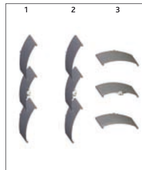
Basisversion: 1. Absenken des Behangs mit geschlossenen Lamellen, 2. geschlossene Raffstore, 3. Hochfahren mit geöffneten Lamellen
